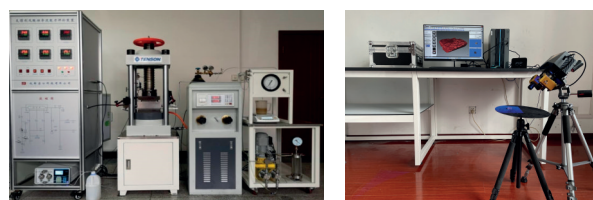
a. 高温高压酸蚀裂缝导流能力测试装置
